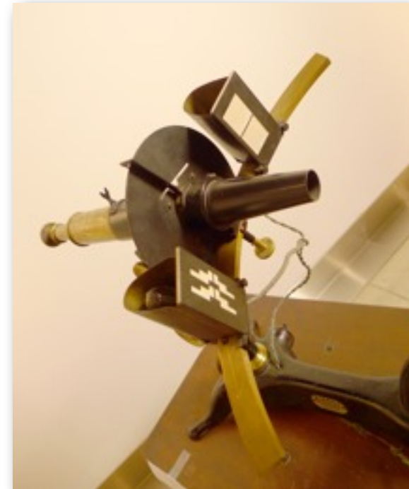
Figura 7. Oftalmómetro de Javal. El observador hace ejecutar una rotación de 90^\circ al antejo para la determinación del segundo meridiano principal
