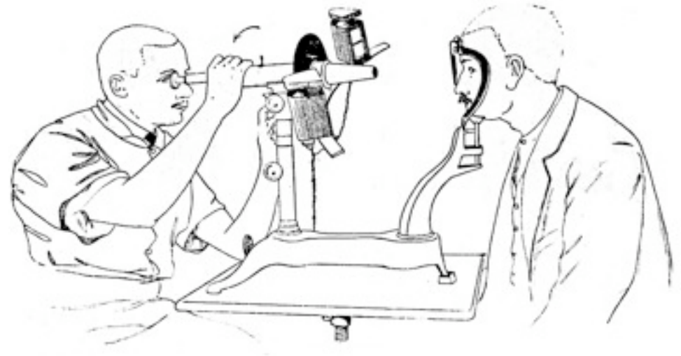
Figura 7. Oftalmómetro de Javal. El observador hace ejecutar una rotación de 90^\circ al antejo para la determinación del segundo meridiano principal
